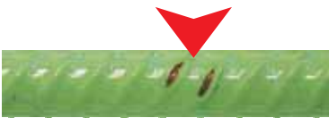
Daño causado por un cabezal vibrador estándar.
