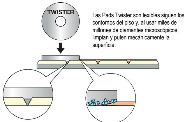
Las Pads Twister son flexibles siguen los contornos del piso y, al usar miles de millones de diamantes microscópicos, limpian y pulen mecánicamente la superficie.
