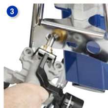
3 Utilice el racor hexagonal del bastidor para aflojar la bomba y extraer el cartucho
