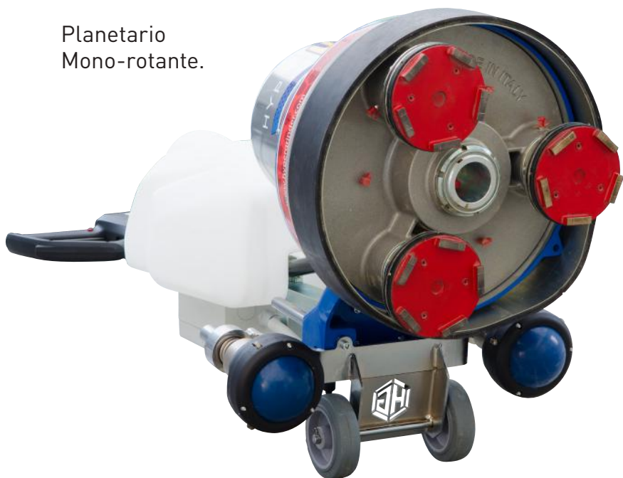
Planetario completamente con ingranaggi in acciaio temperato. Massima affidabilità e performance.
