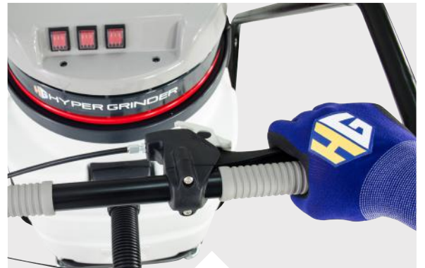
Cómoda palanca para levantar la escobilla de goma.
